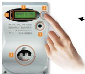
SE DISPONE DI UN CONTATORE ELETTRONICO COME QUELLO IN FIGURA DEVE PREMERE SUL PULSANTE DI LETTURA INDICATO DALLA FRECCIA E REGISTRARE DI SEGUITO I DATI CHE LEGGE IN SEQUENZA.
